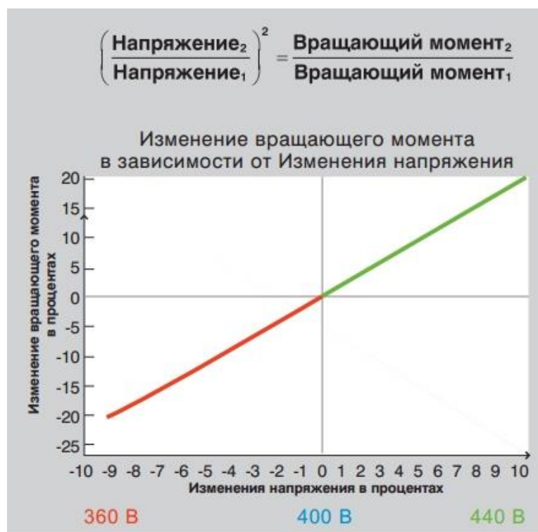
Рисунок 2.1 – Влияние изменения напряжения на вращательный момент
